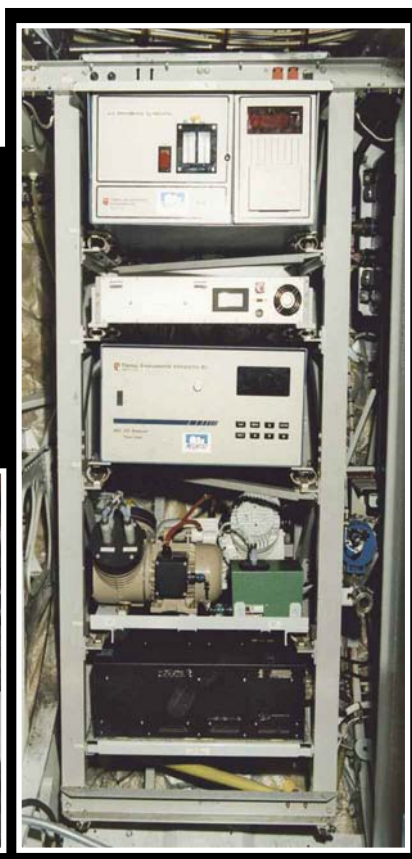
Figure 2a et 2b - Instrumentation Mozaic installée dans la soute avionique de l'A340, sous le cockpit de pilotage. (a) l'étagère installée en 1994 et comprenant de haut en bas l'instrument O_3 , le système d'acquisition, l'instrument CO , les pompes et le module d'alimentation (poids total 134 kg). (b) l'instrument NO , installé en 2001 (poids 50 kg).
